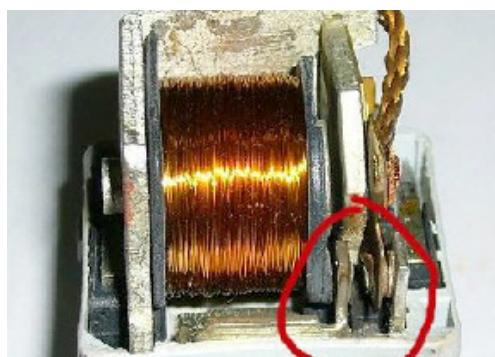
更换继电器后尝试切换模式，电能成功切入，测量实际值发现真空压力偏高没变化，踩放刹车踏板真空值下降的很慢，同时真空泵运转几秒后就关闭了，拔开连接真空泵的真空管接头再次启动看是否是管堵塞了，结果真空泵还是一样运行几秒就停止了。
