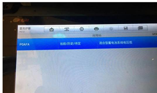
因为该故障码和未维修前出现的故障不一样，为全新的故障代码。维修师傅怀疑可能在安装过程中，某个线路插头未安装到位导致的，所以重新进行拆装、排查线路，再次安装后，启动车辆时系统依然报此故障。
